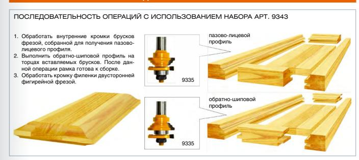
Для уменьшения нагрузки на двигатель фрезерной машины при работе горизонтальными фигирейными фрезами большого диаметра можно эту операцию разделить на три операции с использованием фрез меньшего диаметра, а именно:
