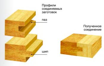
Комбинированные фрезы могут быть использованы не только для изготовления рамочных соединений, но и для выполнения сплачивания и сращивания столярных заготовок.
