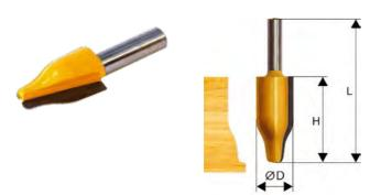
Фигирейные вертикальные фрезы предназначены для глубокого фрезерования кромок столярных изделий (филенок). Данные фрезы позволяют получить за один проход декоративное обрамление и шип по кромке заготовки.
